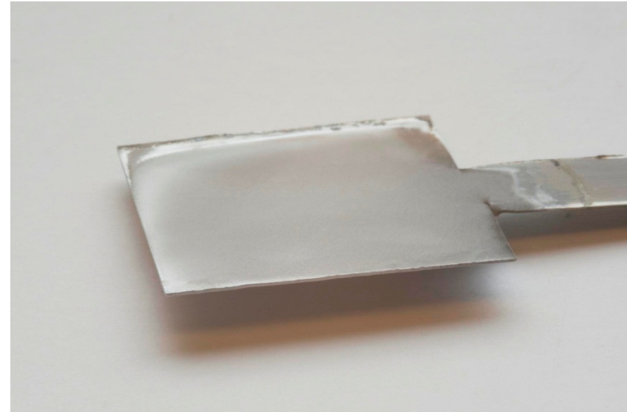
Aluminium-Abscheidung auf einer Stahlprobe (Fläche: 25x25mm)
