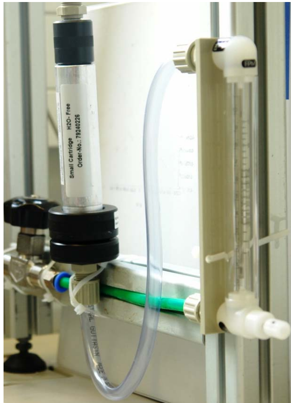
Kommerzielle Gastrocknung mit Molsieb
